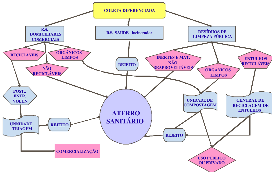
Figura 5: modelo proposto para o gerenciamento integrado de limpeza urbana.
